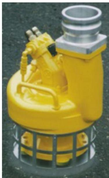
Cette pompe est idéale pour le pompage de liquides à haute viscosité tels que les huiles brutes, le latex, la mélasse et des déchets de raffinerie à l'aide d'une vis de déplacement positif. Lors du pompage de matériaux plus légers, une roue de type centrifuge offrant une capacité élevée prend le relais.
