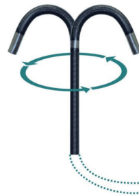
Joystick pour le contrôle du béquillage à 180° ou 360° (selon caméra)
