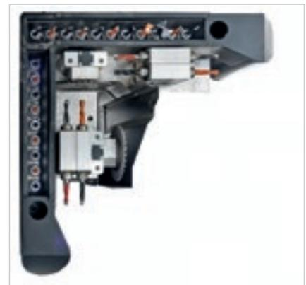
La nouvelle tête de perçage BH30 2L est munie d'une lubrification automatique et d'une aspiration en métal pour une plus longue durée dans le temps. Elle est refroidie par un liquide pour garantir le maximum de précision.
