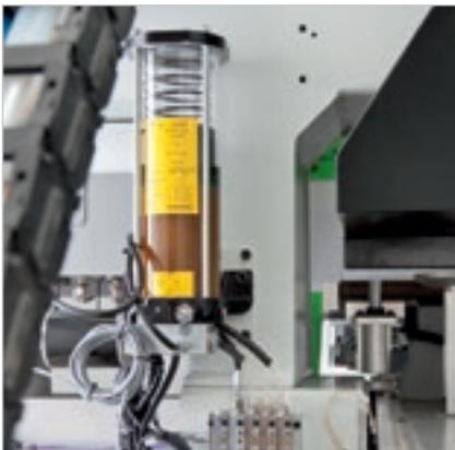
La **lubrification automatique** garantit la lubrification continue des principaux organes d'actionnement de la machine sans l'intervention de l'opérateur.
