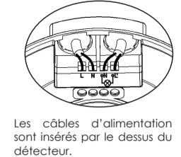
Les câbles d'alimentation sont insérés par le dessus du détecteur.
