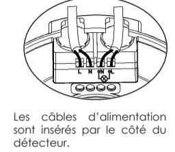
Les câbles d'alimentation sont insérés par le côté du détecteur.
