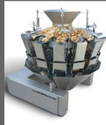
Possibilité de décharge en dynamique: pour décharger dans des barquettes en mouvement.
