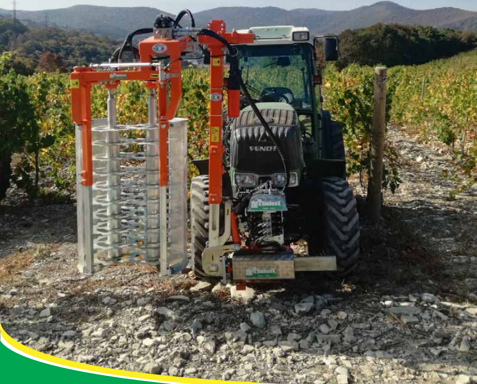
CPL VISION 1 PLUS - PRE-POTATRICE SU TELAIO VISION PLUS - PRE-PRUNING MACHINE ON VISION PLUS FRAME - PRETAILLEUSE SUR CHÂSSIS VISION PLUS - VORSCHNEIDER AN RAHMEN VISION PLUS - PRE-PODADORA EN CHASIS VISION PLUS
