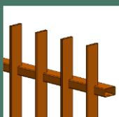
Barreaux 50 x 50 mm, en partie intégrés dans la lisse
