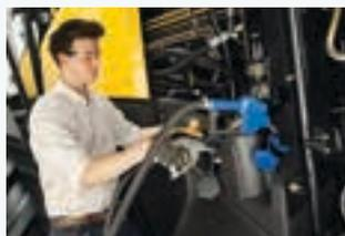
Le réservoir de carburant et celui de 200 litres d'AdBlue sont logiquement situés côte à côte pour faciliter leurs remplissages simultanés. Ils sont éclairés en standard.
