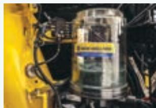
Le système de graissage automatique et centralisé est facile d'accès.
