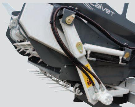
**Pailleur repliable hydraulique très compact sous la caisse.** Le pailleur peut être replié quelle que soit la position de la caisse
