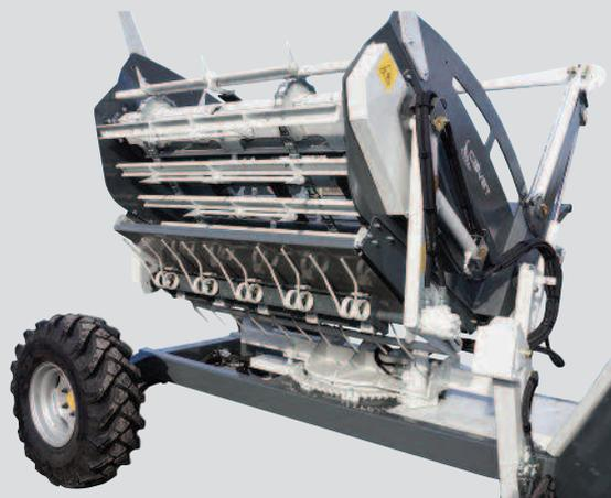
**Caisse inclinable** pour charger la balle avec le bras à réglage hydraulique et retenir la balle pour l'empêcher de monter (meilleur déroulage jusqu'à la fin de la balle)
