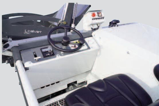
**Poste de conduite** avec volant, siège, direction hydraulique, pédales avancement et recul hydrostatique avec pompe à débit variable. Commandes électriques sur le tableau de bord. Une roue motrice 400/60x15.5 et 2 roues 11.5/80x15.3
