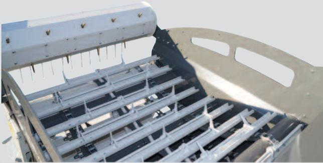
Caisse inclinable tôlée à dents escamotables avec diviseur de débit réglable pour la vitesse de rotation.
