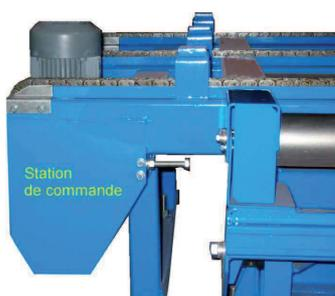
Détail station de commande du convoyeur à chaînes posé sur le transfert
