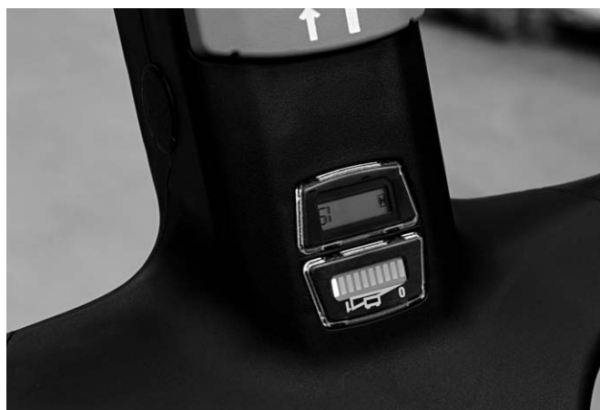
Simple à lire : affichage pour le niveau de batterie et le nombre d'heures de fonctionnement
