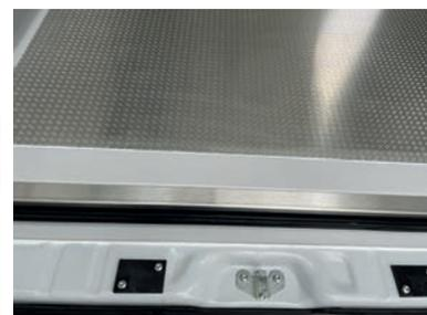
Seuil porte arrière et plancher aluminium antidérapant ( option ).
