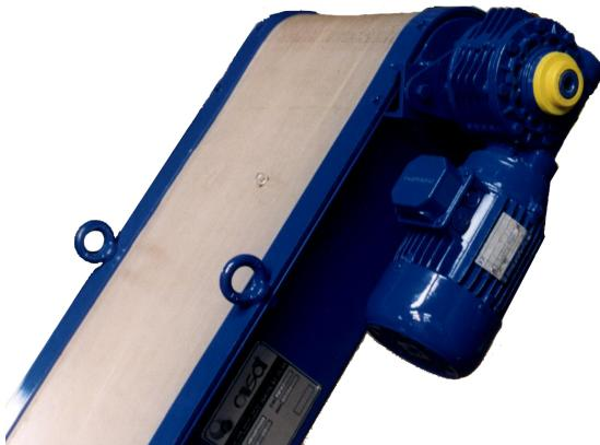
Les convoyeurs magnétiques à aimants permanents sont utilisés pour le transport de copeaux de petites dimensions acier ou fonte (poussières et boues), de pièces et déchets métalliques. Le mélange de liquide et de copeaux se déverse sur la partie horizontale du convoyeur. Les copeaux sont emmenés par des barrettes d'aimants permanents au travers d'une tôle en inox dans la benne. Il existe différents types d'aimants : Ferrite et Néodium (forte attraction).
