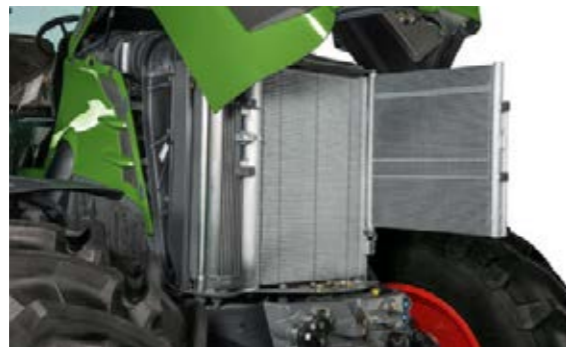
Le radiateur est également facile d'accès, ce qui facilite le nettoyage.
