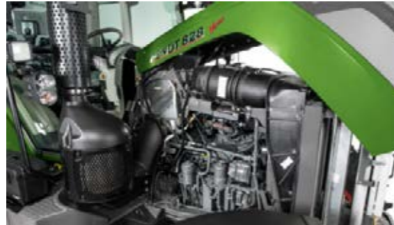
Le capot relevable et les panneaux latéraux amovibles assurent un accès aisé au compartiment moteur.
