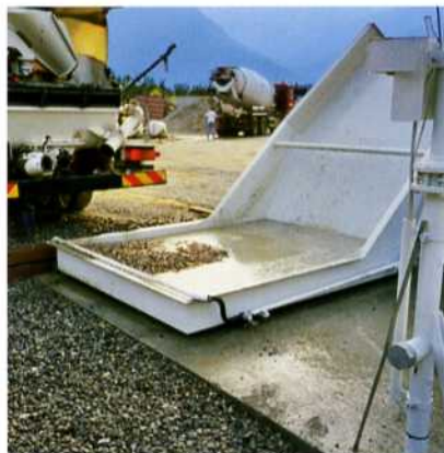
Skip hydraulique pour la réception des matières résiduelles depuis la pompe à béton, capacité de 1100 litres.
