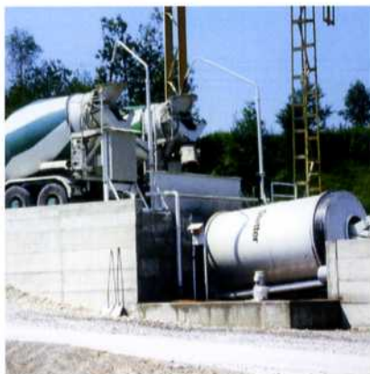
Modèle en fosse avec déversement au niveau du sol.
