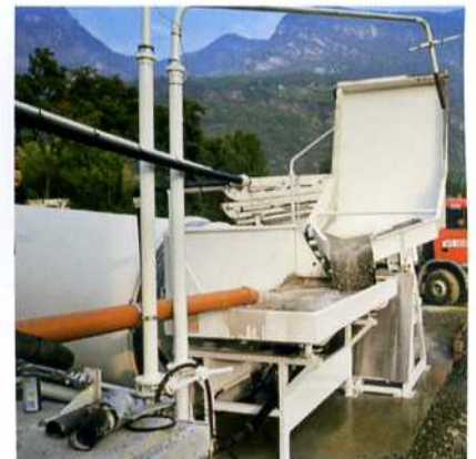
Skip hydraulique pour la réception des matières résiduelles depuis la pompe à béton, capacité de 1100 litres.
