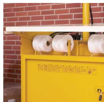
Les rouleaux de ruban sont faciles à remplacer à l'avant de la machine.
