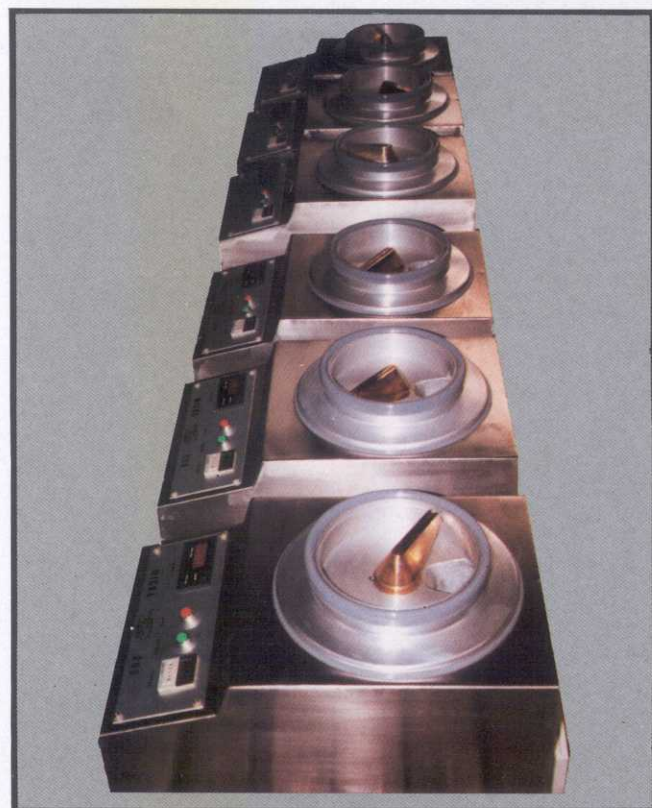
Fabricación en serie de la MICRA 200 , con bancada en acero inoxidable y cámara de tamizado con barredor en bronce.
