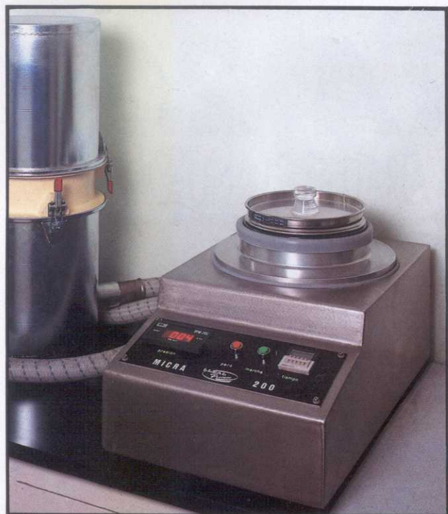
Tamizadora a chorro MICRA 200 con tamiz y tapa en posición de trabajo. Detrás, filtro de 1 m 2 para recogida de finos.
