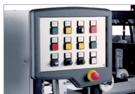
Panneau de commande à touches pour les différentes fonctions de la machine
