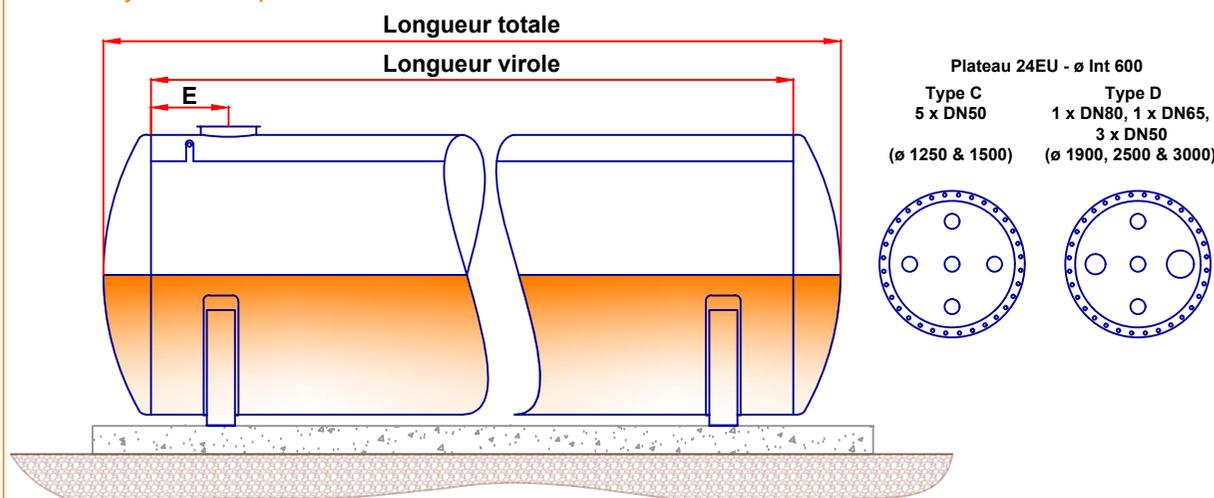
E = 500 / réservoirs ø 1250 et 1500 - E = 900 / réservoirs ø 1900, 2500 et 3000 - E = 700 / réservoirs 8000 & 10000L ø 1 900
