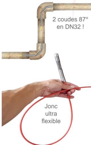
D'un **diamètre** de seulement **14mm**, cette tête de caméra permet de passer aisément jusqu'à **2 coudes** jusqu'à **87°** dans un diamètre aussi petit qu'un **DN32** !
