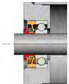
H : Soudure boîtier massif en pleine jupe
