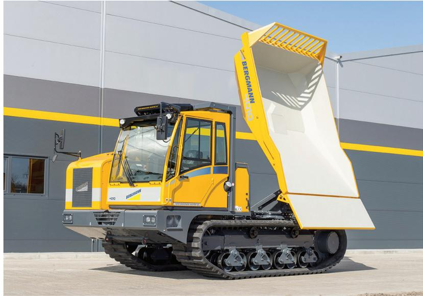
Avec une pression au sol de seulement 0,45 kg/cm<sup>3</sup>, le 4010 remplit, sous forme de basculeur arrière, toutes les exigences des utilisations dans des zones humides et marécageuses, requises dans la construction de pipelines, de digues, le génie hydraulique ou l'industrie de l'extraction.
