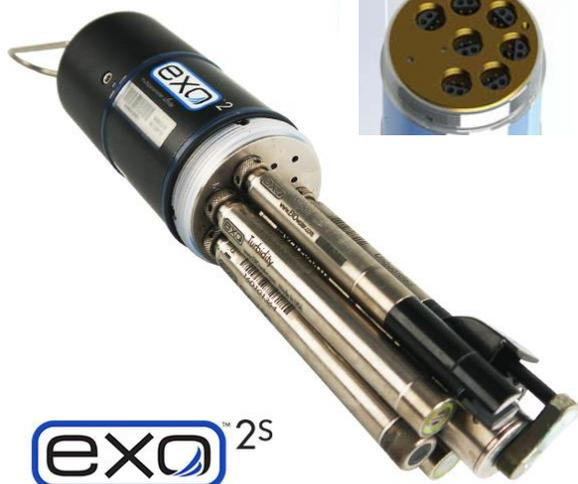
La sonde ExO-2<sup>S</sup> reprend la base bien connue de sa cousine ExO-2 dans l'idée de se centrer sur les applications nécessitant plus de compacité et devant se contenter d'une alimentation externe via le câble submersible: surveillance par bouée ou station de berge, découverte et arpentage par robots, AUV et drones, collecte & transmission de données.
