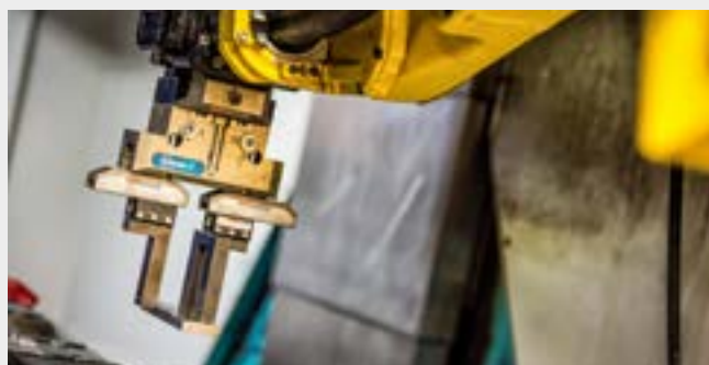
Positionnement robotisé de pièce
