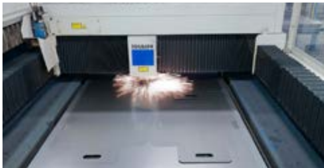
Découpe laser d'une tôle en acier
