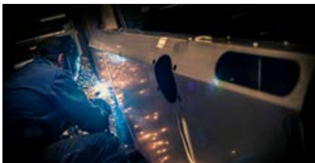
Soudage à la main d'un bâti
