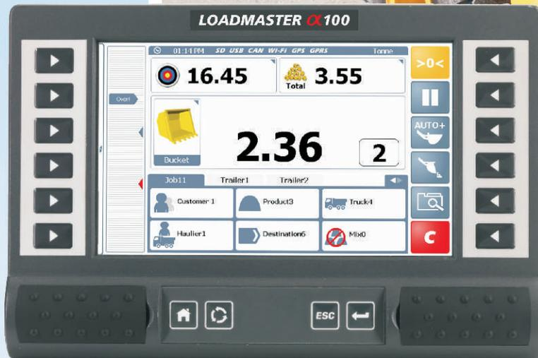
Le **LOADMASTER  $\alpha$ 100** est un nouveau système BUS-CAN établissant une réelle avancée pour les utilisateurs. Il associe une technologie de pointe de plusieurs capteurs et un logiciel de calcul évolué, afin de donner les informations précises du poids du produit.
