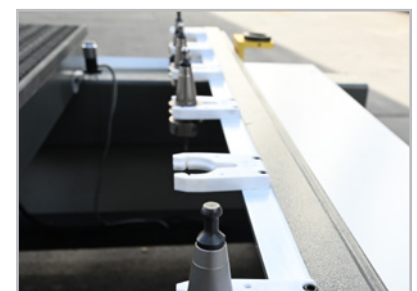
Changeur d'outils · Intégré avec un magasin de 6 outils (ISO 30) · Idéal pour réaliser des pièces complexes avec un seul programme
