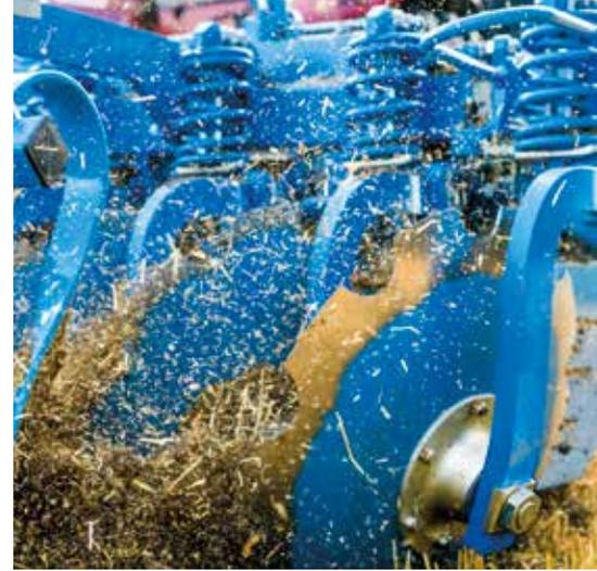
Jusqu'à présent, les déchaumeurs à disques compacts assuraient un mélange homogène intensif de sol et matière organique jusqu'à une profondeur de travail d'environ 14 cm.
