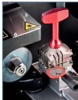
Station de taillage clés plates et cruciformes
