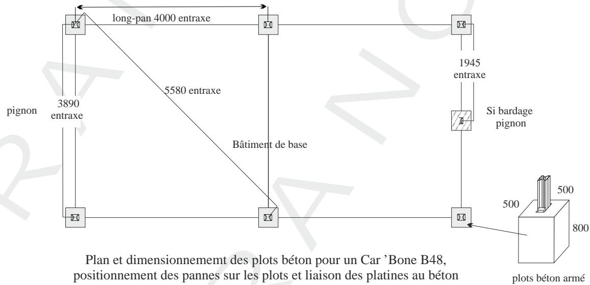
Plan et dimensionnement des plots béton pour un Car'Bone B48,
