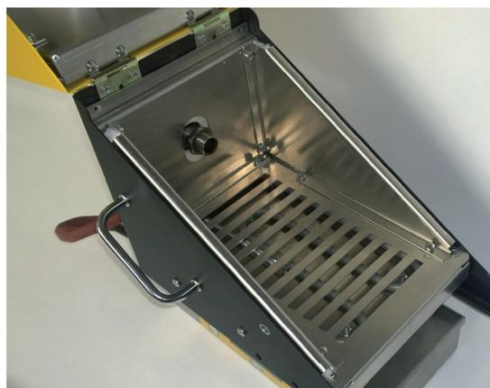
La température du tube chauffé et la température du boîtier externe peuvent être régulées jusqu'à 200°C et sont commandées indépendamment par le thermorégulateur qui est situé sous le boîtier externe.
