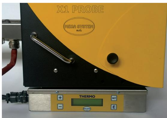
Le capteur T1 permet de mesurer la température du filtre du boîtier interne, le capteur T2 permet de mesurer la température en sortie du condenseur pour les micropolluants.
