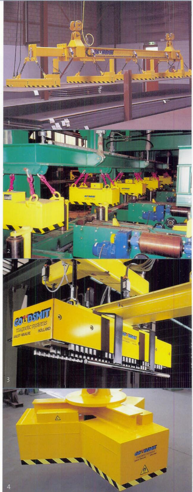
Ces aimants sont spécifiquement utilisés pour le levage de gerbes. Les gerbes ont une surface irrégulière. Ceci complique le levage. Un aimant spécialement conçu avec un champ magnétique très profond est insensible à cette irrégularité et permet de déplacer les gerbes en toute sécurité et sans problèmes.
