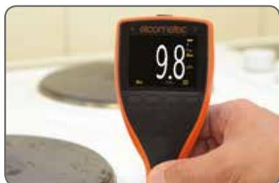
Idéale pour mesurer l'épaisseur de film sec sur des substrats fins.
