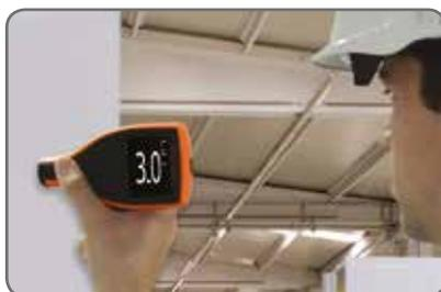
Écran à rotation auto à 360° pour une bonne visibilité quelque soit l'angle de mesure, sur la chaîne de production ou au poste AQ.
