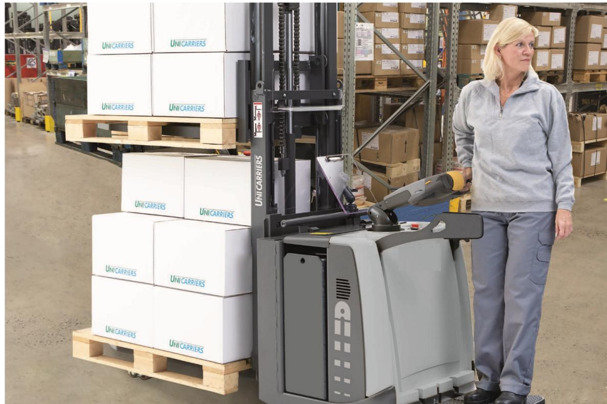
D'une largeur inférieure à celle d'une palette Europe, le PDP 200 a une capacité totale de 2000 kg (1000 kg + 1000 kg en manutention double palette) et une hauteur de levée maximum de 2090 mm. Son moteur de traction AC de 2,2 kW et sa vitesse de pointe de 12,5 km/h contribuent au rendement élevé de ce gerbeur double palette efficace avec sa plateforme porté debout (en option).
