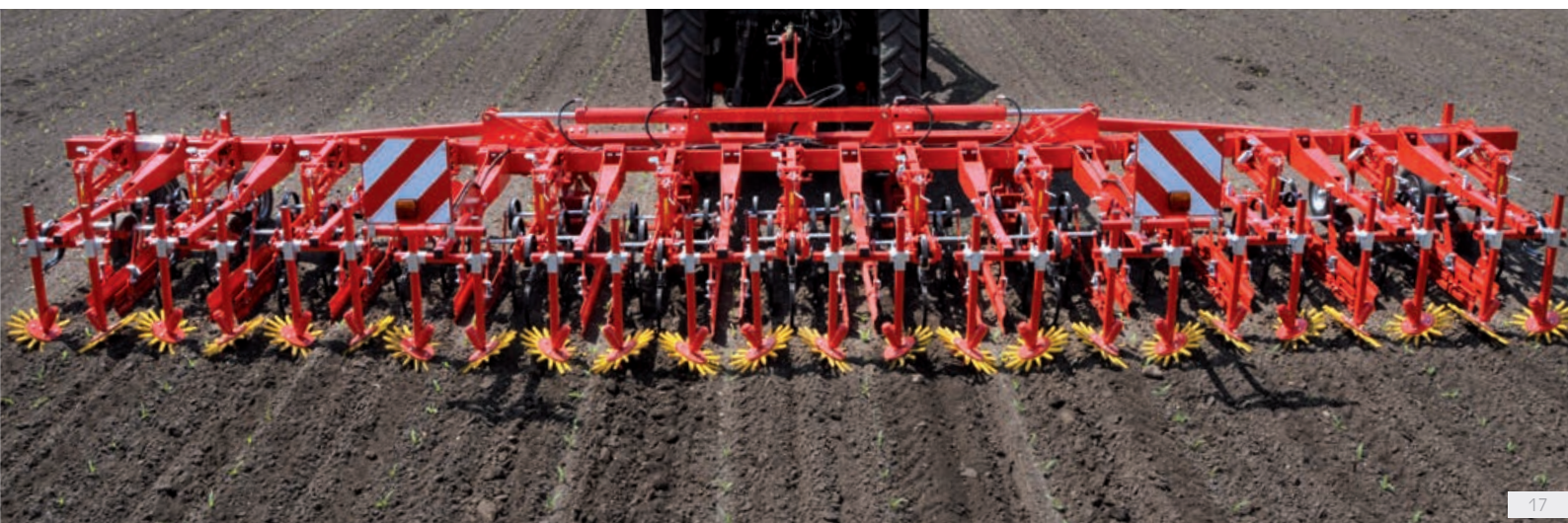
Les cultures nécessitant un binage superficiel, la CHOPSTAR 60-90 cm est livrable avec des dents patte d'oise.
