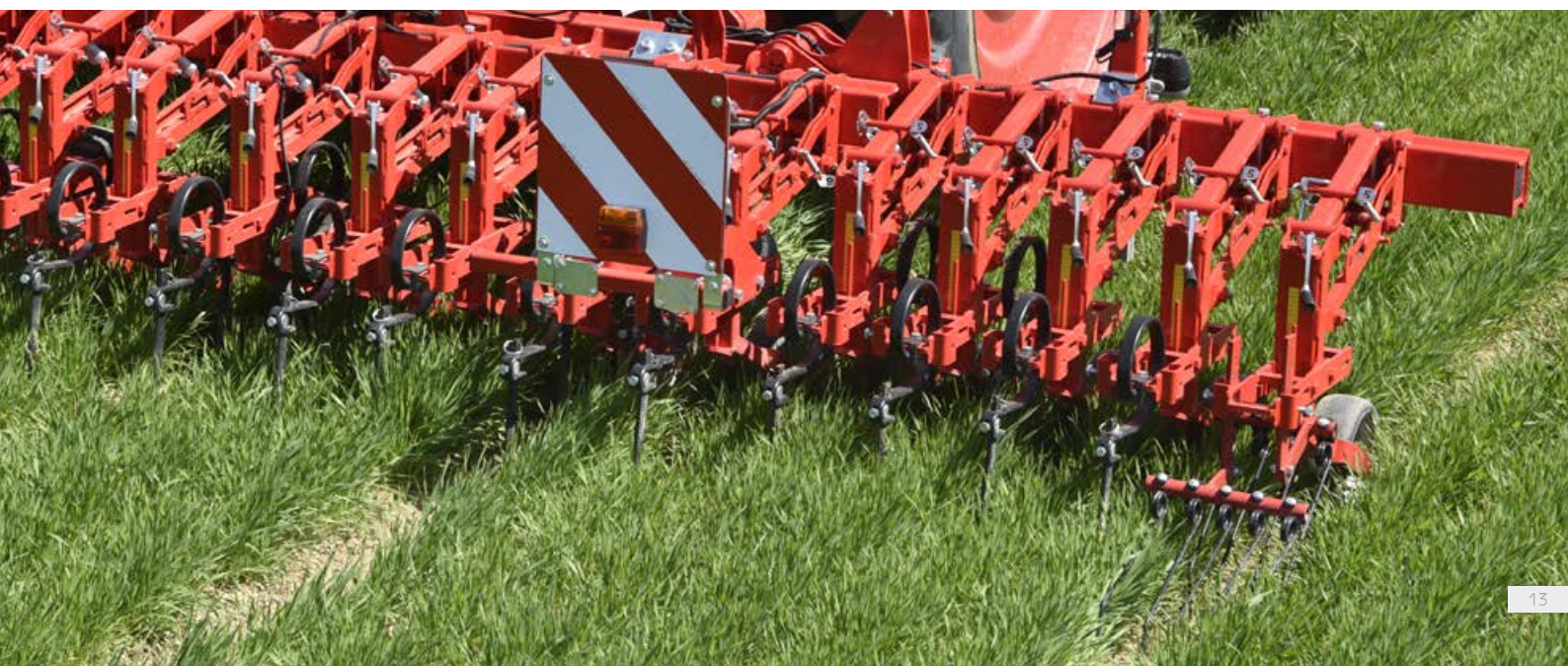
Tôles de protection pour élément de binage CHOPSTAR 20-30 cm, à partir d'un entre-rang de 25 cm
