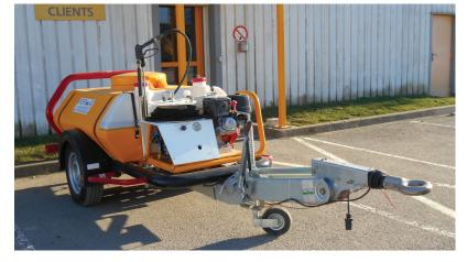
Avec un réservoir en polyéthylène de 940 litres, couvercle de diamètre 450 mm, une jauge à niveau, des bacs intégrés pour l'antigel et les détergents éventuels, un enrouleur pour le flexible HP et un support pour les lances. Ce nettoyeur haute pression Brendon est placé dans le haut de gamme dans l'industrie du nettoyage industriel, construction, communes, naval, béton désactivé et l'environnement.
