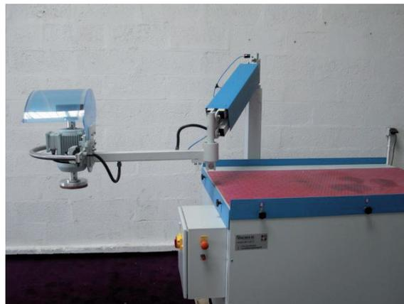
Le bras ergonomique permet de travailler en dehors de la table afin d'accéder à des pièces plus volumineuses.
