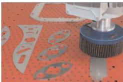
Les pièces sont posées sur un tapis à fort pouvoir adhésif ; le disque travaillant parallèlement à la table, les pièces restent parfaitement en position.
