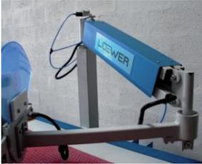
Le bras articulé monté sur palier avec équilibrage de poids est facilement manipulable et permet un travail rapide et confortable.
