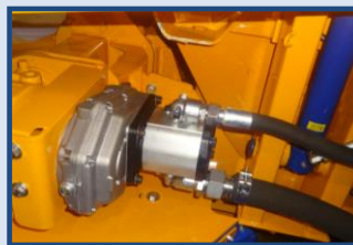
Centrale hydraulique pour le convoyeur et démêleurs (si distribution démêleurs et tapis pvc)
