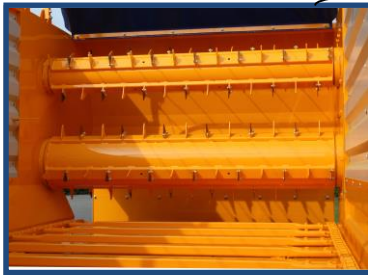
Deux démêleurs mécaniques sur modèles S et M Trois démêleurs mécaniques sur modèles L et XL Modèle PREMIUM (démêleurs et tapis pvc fixes)
