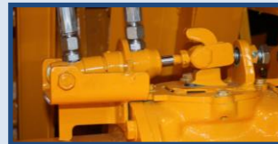
Vérin hydraulique pour la commande de fourchette de la faucheuse
