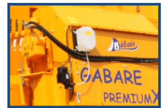
Graissage automatique des chaînes de convoyeur
