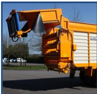
Porte arrière hydraulique pour modèles premium avec tapis pvc et démêleurs Les démêleurs restent fixes sur la caisse
