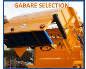
Porte arrière hydraulique pour modèles SELECTION avec tapis pvc et démêleurs (les démêleurs sont incorporés dans la porte)
