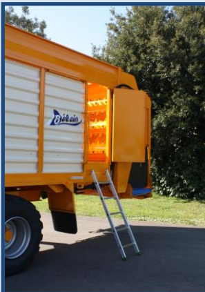
Porte latérale avec échelle d'origine sur tous les modèles de la gamme SELECTION, uniquement sur modèle avec démêleurs et tapis pvc sur la gamme PREMIUM
