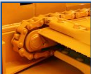
Chaînes plates haute résistance Barrettes de fond mouvant en tube de forte section boulonnées
