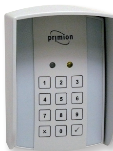
prime prox moulé dans son boîtier de protection aux intempéries et de confidentialité
