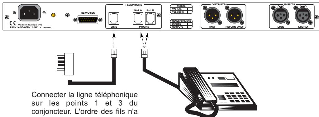
**Attention !** suivant le type d'appareil téléphonique utilisé, le câblage du cordon n'est pas identique.
