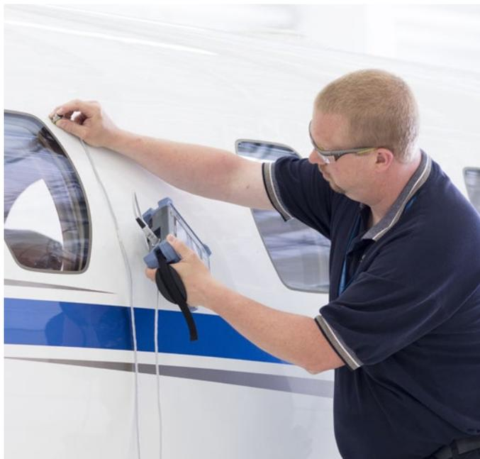
Le mode de résonance du BondMaster 600 est une façon simple et fiable de détecter les délaminages. Souvent, la profondeur du délaminage peut être estimée à partir de la rotation de phase du signal. Ce mode est remarquablement facile à utiliser, principalement grâce aux réglages prédéfinis en usine pour les applications de décollement des matériaux composites stratifiés et des structures métal sur métal.
