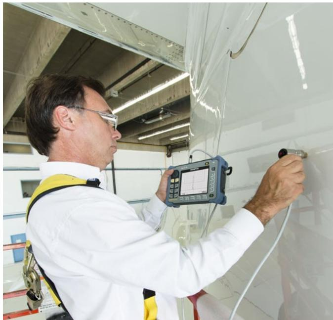
En plus d'afficher des lectures en temps réel indiquant l'amplitude ou la phase du signal, le BondMaster 600 offre aussi une nouvelle vue de balayage permettant de vérifier l'amplitude et la phase de la sonde dans le temps, ce qui facilite la détection des petits décollements.
