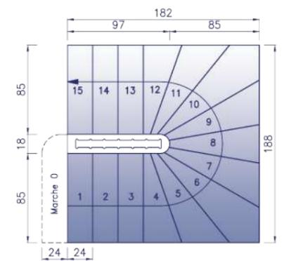
Hauteur à monter B2M 85 : tolérance admissible + 2 cm de moyenne, suivant modèle.
