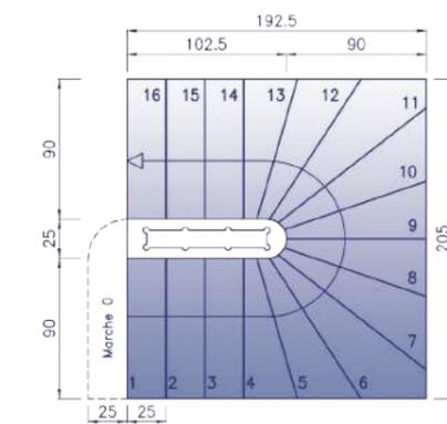
Hauteur à monter B2M 90 : tolérance admissible + 2 cm de moyenne, suivant modèle.
