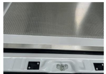
Seuil porte arrière et plancher aluminium antidérapant ( option ).
