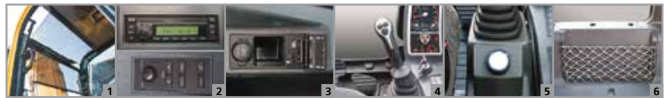
1 Pare-soleil enroulable 2 Radio / MP3 avec télécommande 3 Téléphone cellulaire mains libres 4 Joysticks ergonomiques 5 Molette d'accélérateur avec DEL-éclairage 6 Compartiments de rangement
