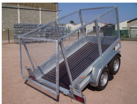
Rehausse arrière basculante et articulée par le haut
