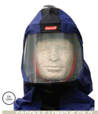
Cagoule longue (250 g) avec couverture du cou et des épaules, ventilation optimale, vision large non déformée, 2 joints de serrage, serre-tête réglable à 3 points, maintien par 2 élastiques, protection TH3.
