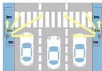
Rue à sens unique sur 3 bandes : un second luminaire est nécessaire de l'autre côté de la chaussée.
