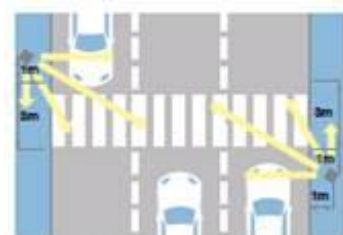
Rue à double sens : un minimum de deux luminaires est nécessaire pour créer un contraste positif pour le trafic dans les deux sens.
