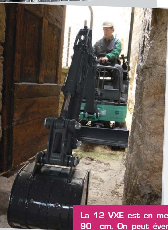
La 12 VXE est en mesure de passer une porte de 90 cm. On peut éventuellement basculer l'arceau pour en faciliter le passage.
