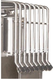
Un pour chaque composant différent ; ils peuvent être chargés manuellement ou pneumatiquement (par une lance d'aspiration à plonger directement dans le produit contenu en sacs ou par transport pneumatique d'une trémie vide-sacs). Les réservoirs chargés pneumatiquement sont équipés d'indicateurs de niveau produit, maxi et mini, et la capacité peut être déterminée selon les besoins.
