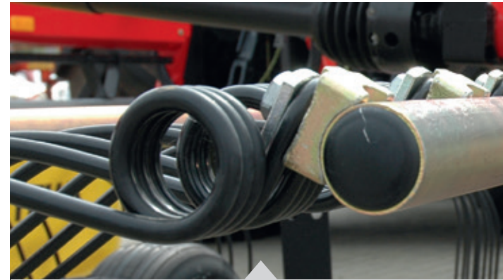
Partie avant absolument lisse du bras porte-dents
