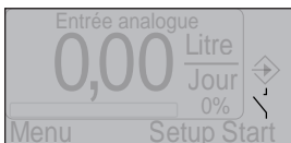
Fig. 51 : Écran de démarrage "Entrée analogue" avec symbole d'un contact ouvert
